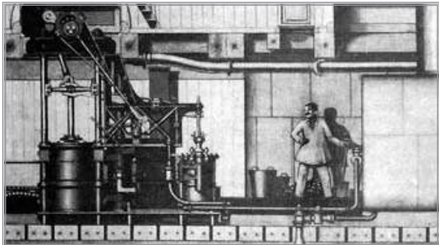
Машинно-котельное отделение парохода «Метеор» (прод. разрез)
