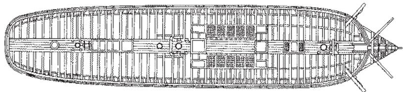
Чертеж квартер-дека и форкастеля
